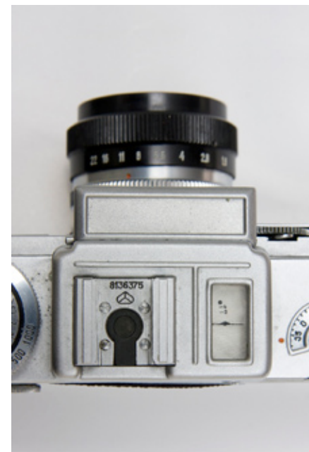
Z lewej - wskazówka światłomierza jego prawidłowe ustawienie (0 EV). Z prawej widoczna rozłożona korbka przewijania filmu.
