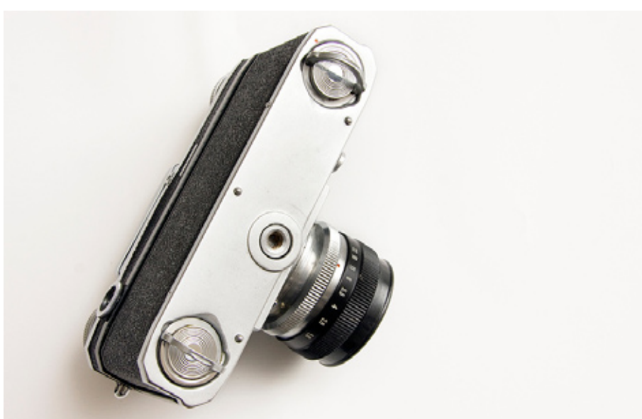
Górna fotografia ilustruje sposób otwierania aparatu. Na dolnej widoczne są zwolnione zamki tylnej ścianki aparatu
