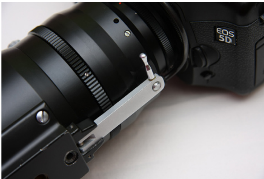
Połączenie EOS-a 5D i Taira 4,5/300 daje wyobrażenie o rozmiarach tego obiektywu. Doskonale widać pokrętko ostrości oraz - na dolnej fotografii dźwignię zwalnającą przesłonę.
